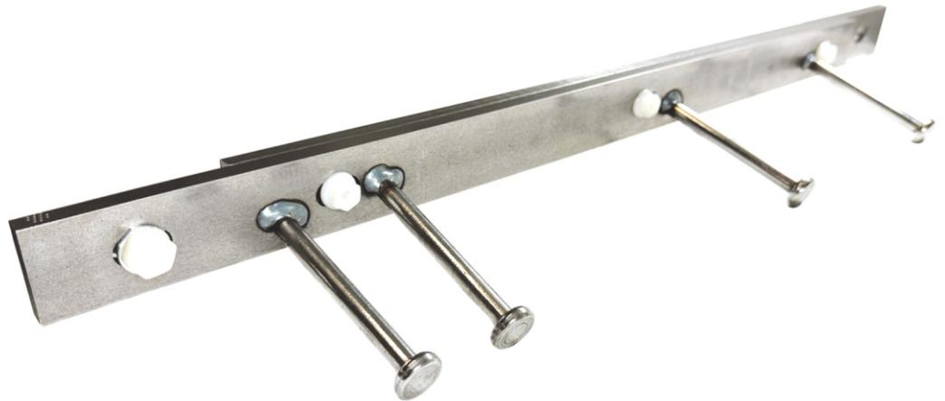
Das Conecto Strip Joint-Profil kombiniert die Stärke einer Stahlbewehrung mit der Zweckmäßigkeit einer Holzschalung. Es wird beim ersten Betonieren an der Oberseite des Holzes befestigt und bleibt nach dem Entfernen der Schalung sicher an Ort und Stelle und bietet so einen zuverlässigen Kantenschutz. Mit seinen Stahlstreifen ist es ideal für Industrieböden und Lagerräume. Mit einer Standardlänge von drei Metern bietet es eine praktische und effiziente Lösung für anspruchsvolle Bauanforderungen.
